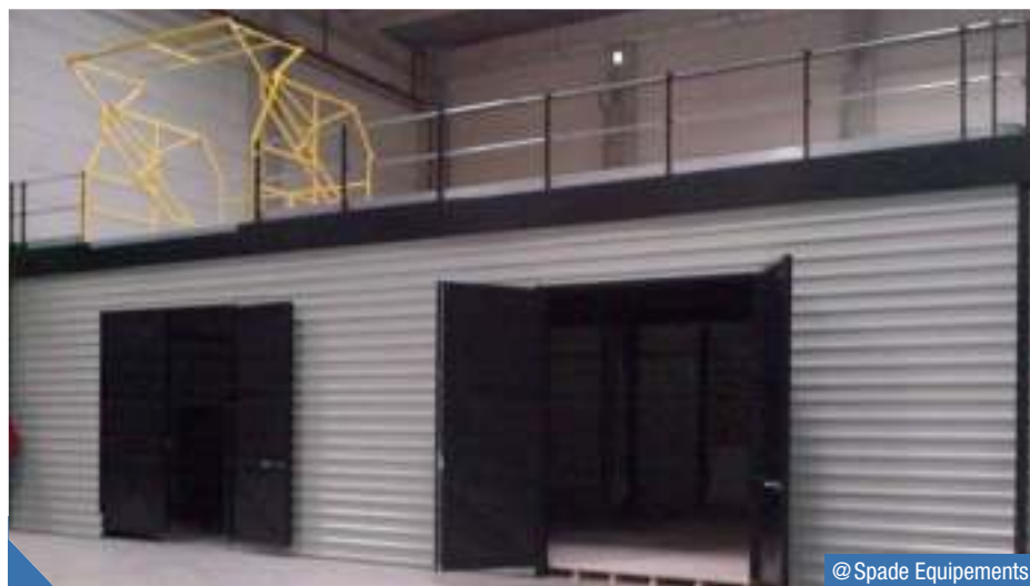
Structure porteuse équipée d'un bardage pour création d'un studio photo.
